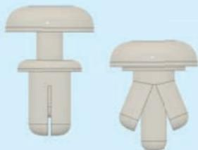
穴に入れて頭を押し込むことで、穴の中で部品<sup>あたま</sup>が広がり穴から抜けなくなります。取り外した<sup>ぶひん</sup>いは頭の部分だけを引き抜いてください。
